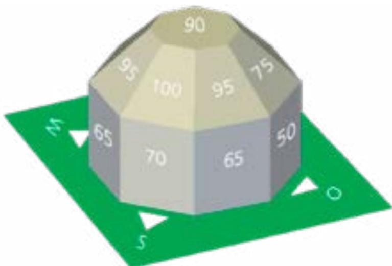
Die Ausrichtung der Solarmodule hat einen gewissen Einfluss auf die produzierte Elektrizitätsmenge, ist aber im Verhältnis zu möglichen Verschattungen weniger wichtig. Die Verschattung durch Berge, Nachbarbauten, Bäume, Kamine, Lukarnen u. a. kann die Produktion erheblich beeinträchtigen.
