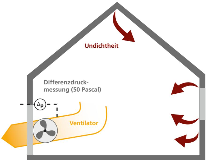
Für die Messung der Luftdichtheit wird eine spezielle Türe mit Ventilator eingesetzt. Dieser erzeugt im Gebäude einen Unterdruck. Bei Undichtheiten strömt Luft nach. Ist der Volumenstrom zu gross, müssen die Undichtheiten behoben werden.
