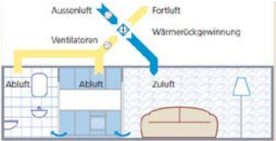
Deckenauslässe haben den Vorteil, dass die Möblierung nicht eingeschränkt wird und weniger Schmutz in die Lüftung gelangen kann.
