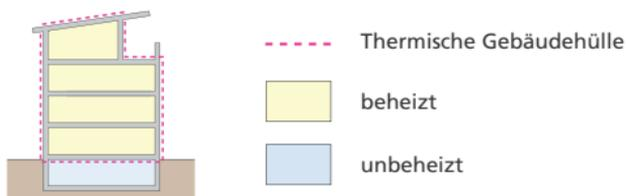
Mit einer Aufstockung wird zusätzlicher Wohnraum geschaffen. Das bestehende Volumen wird dementsprechend vergrössert. Der neue Gebäudeteil ist mit seinen Konstruktionen als Neubau mit den entsprechenden energetischen Neubauanforderungen zu betrachten.
