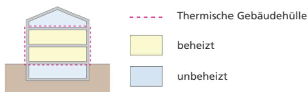
Die Wärmedämmung wird auf der Decke zwischen Wohnraum und kaltem Estrichraum angebracht. Der Dachraum bleibt weiterhin unbeheizt und kann als Abstellfläche genutzt werden. Die Dämmung wird auf den Estrichboden verlegt und mit einer Schutzschicht abgedeckt. Diese Maßnahme ist kostengünstig und hat einen hohen energetischen Nutzen, hingegen nimmt im Estrichboden die Raumhöhe ab.
