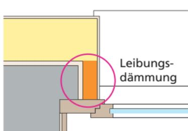
Mit dem Ersatz der Fenster sind die Leibungen mit mindestens 2 cm – oder besser mehr – zu dämmen. Ist dies nicht sofort möglich, sollte das Fensterlichtmass so geplant werden, dass eine spätere Fassadendämmung dies zulässt.
