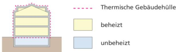
Damit der bisherige Kaltraum als Wohnraum genutzt werden kann, muss eine Wärmedämmung in der Ebene der bestehenden Dachkonstruktion eingebaut werden. Die Dachdämmung wird entweder unter, zwischen oder über der vorhandenen Dachkonstruktion angebracht. Die bauphysikalischen Anforderungen (v. a. Luftdichtigkeit, sommerlicher Wärmeschutz) sind sorgfältig zu beachten. Die empfohlene Dämmstärke beträgt 20–30 cm.
