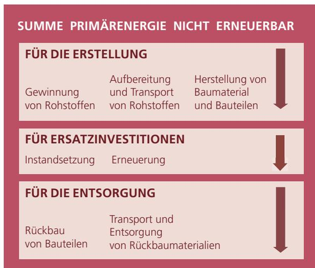
Die Grafik zeigt die Systemgrenze der grauen Energie. Der Betrieb und Unterhalt eines Gebäudes liegen ausserhalb der Systemgrenze. Der Transport auf die Baustelle sowie der Baustellenbetrieb werden bei der Berechnung in der Regel vernachlässigt.
