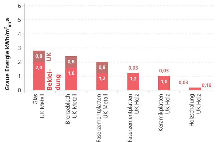
Glas ist nur in Kombination mit einer Unterkonstruktion aus Metall sinnvoll und schneidet am schlechtesten ab. Eine Holzschalung wird dagegen immer auf einer Unterkonstruktion aus Holz befestigt. Zwischen diesen beiden Fassadenkonstruktionen liegt ein Faktor von etwa 15! Das zeigt die grosse Bedeutung einer bewussten Materialwahl. Ferner lässt sich die Differenz der Unterkonstruktionsarten direkt an den zwei Beispielen mit Faserzementplatten ablesen und beträgt 0,8 kWh/m²<sub>BTF,a</sub>.
