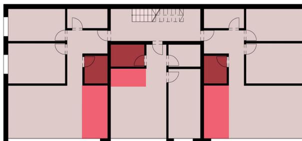
Die hellroten Bereiche stellen Küchen und die dunkelroten Bereiche Nasszellen dar. Die zusammengefasste Anordnung vereinfacht die Führung von Steigleitungen und verkürzt die Verteilwege.
