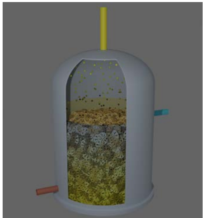
Abbildung 3: Anaerobfilter mit Plastikkörpern, welche die Mikroorganismen zurückhalten
