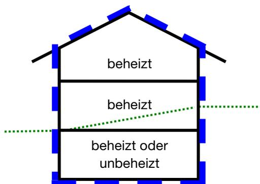
Wenn das gesamte Untergeschoss innerhalb der thermischen Gebäudehülle liegt, die Wärmdämmung von Außenwand und Dach bei keinem Anschluss durchdrungen, das Fenster gemäss Seite 15 eingebaut wird und einen  $\Psi$ -Wert von maximal 0.15 W/mK aufweist, gilt der Wärmebrückennachweis als erfüllt.
