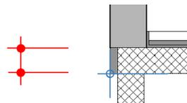
**Flankendämmung**      Wärmedämmung an Bauteilflanke
