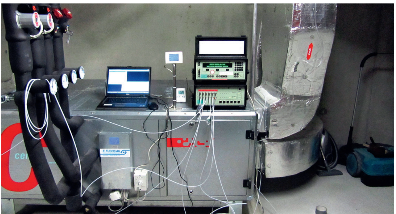
Leckagen des Lüftungssystems können mit der Tracergasmethode bestimmt werden.
