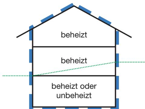
Wenn das gesamte Untergeschoss innerhalb der thermischen Gebäudehülle liegt, die Wärmdämmung von Aussenwand und Dach bei keinem Anschluss durchdrungen und das Fenster an der Kante der Wärmedämmung angeschlagen wird (vgl. Detail), gilt der Wärmebrückennachweis als erfüllt.
